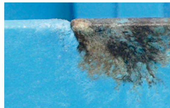
Bild 1. Luftereinschluss mit „Brenner“: Eine zuverlässige Entlüftung von Spritzgießwerkzeugen verhindert Fehlstellen am Formteil ebenso wie Beschädigungen und Verschmutzungen des Werkzeugkonturbereichs
