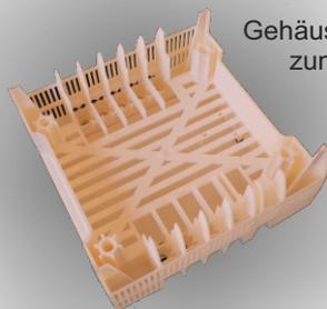
Gehäusebauteil mit Lüftungsschlitzen zum Testen der Wärmeabfuhr
