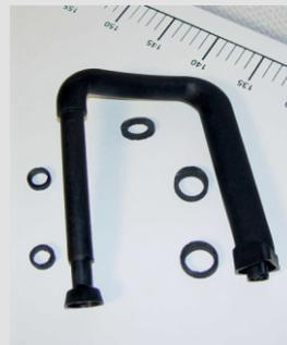
Partnerprojekt GRIFF (Firmen Stieler und Hein): Bei diesem speziellen WIT-Verfahren wird nach einer Teilfüllung das Wasser unter hohem Druck in das entstehende Sackloch gepresst und dann kontrolliert wieder aus dem Bauteil entfernt, so dass das Teil nahezu trocken aus dem Werkzeug fällt.
